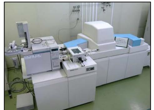
高分解能ガスクロマトグラフィ質量分析計
