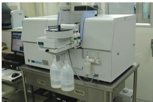
黒鉛炉を電氣的に加熱することで試料溶液を乾燥・灰化し、効率的に原子化することで高感度分析が可能。
