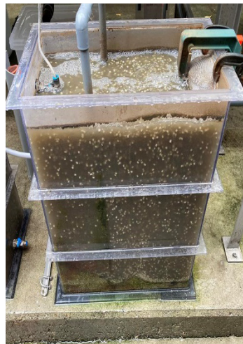
写真1 担体処理試験装置の外観 ※ 担体式廃水処理協会の合同試験例
