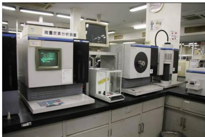
高感度検出器を装備した装置です。弊社で確立した条件を適用することで、高感度定量を可能としました。(極低炭素鋼の分析精度  $\sigma = 0.1\text{ppm}$  at 炭素  $10\text{ppm}$ )
