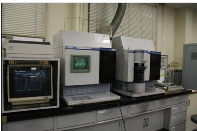
バッファータンク装備により装置の精度が向上しました。試料前処理や分析浴剤の条件最適化により、酸素・窒素の分析精度を画期的に改善しました。
