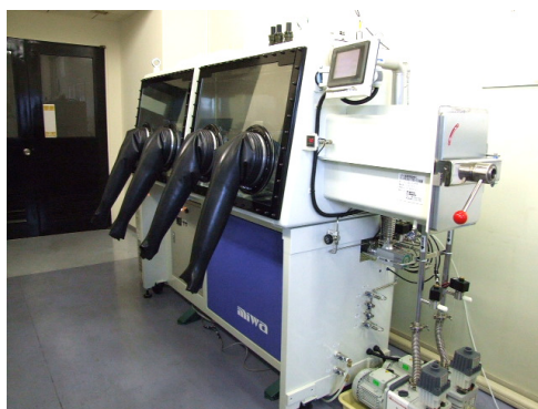
電解質を回収する 雰囲気調整グローブボックス
