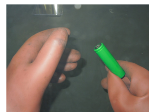
電池解体 解体後に電解質を溶媒で回収し 容器に封入します。
