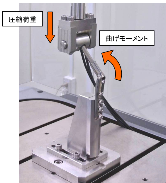
疲労試験外観写真
