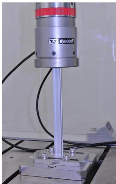
アルミ押出材のねじり疲労試験
