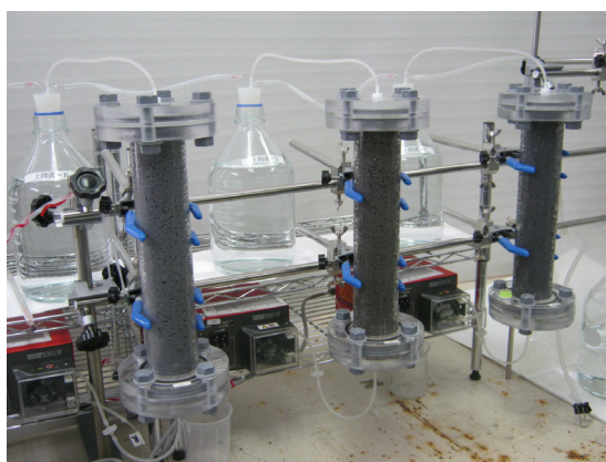
図3 通水式カラム溶出試験状況
