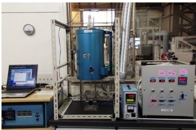
ガス流通式触媒反応試験装置(例)
