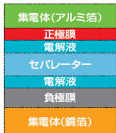
【ラミネート型電池の基本構造】
