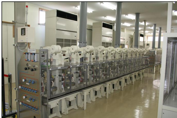
定荷重応力腐食割れ試験(NACE TM0177 Method A)
