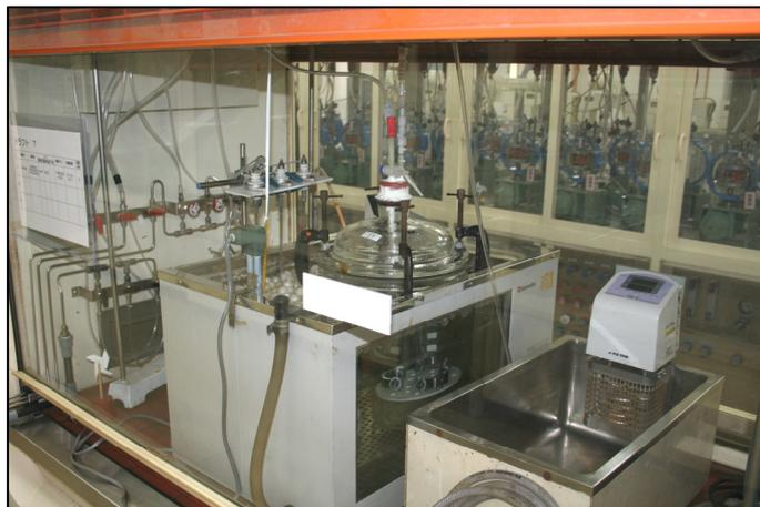
定ひずみ曲げ応力腐食割れ試験(NACE TM0177 Method C, D 他)
