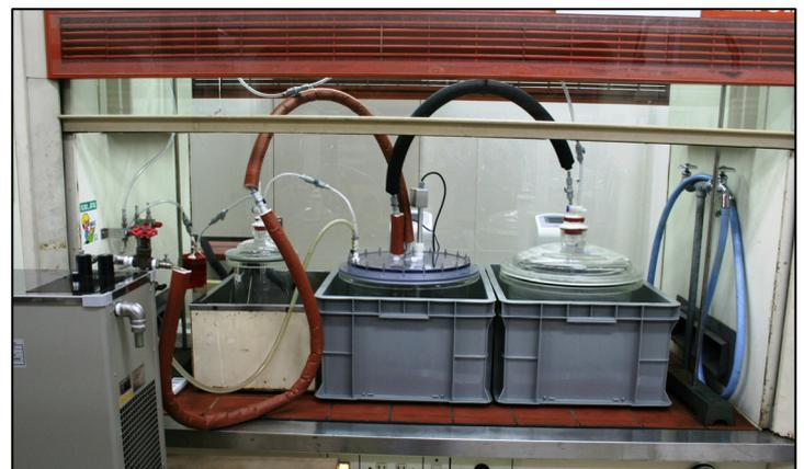
30%硫化水素ガス環境下での腐食促進試験
