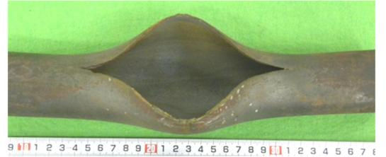
破損事故例：ボイラー管の内圧による破損
