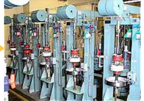
写真は硫化物応力腐食割れ試験の例 (NACE TM0177 2006 Method A)
