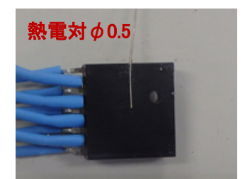
パワーデバイスへの熱電対設置状況 (PKGにスリット加工)
