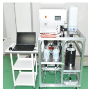
図2 PEM水電解セル劣化加速試験を含むワンストップソリューションの一例
