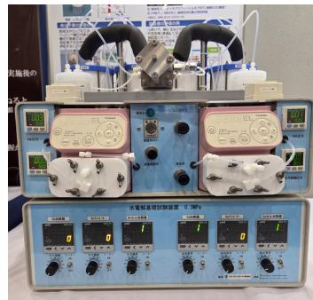
接液部金属フリー評価装置(株式会社ミックラボ/株式会社サンテックコーポレーションと技術連携)
