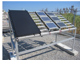
太陽電池モジュールの大気暴露試験の様子（沖縄における暴露試験）
