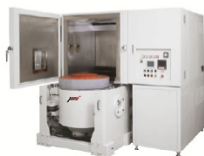
複合環境振動試験機 (-70~180℃ 可能重量400kg)
