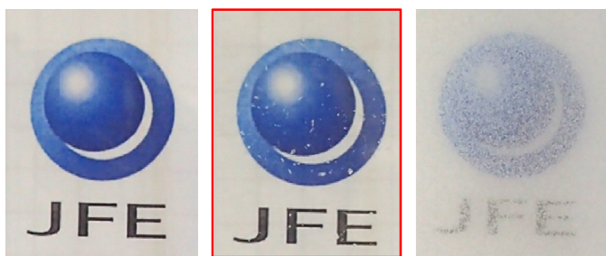
図2 ポリカーボネートのグラベロ試験
