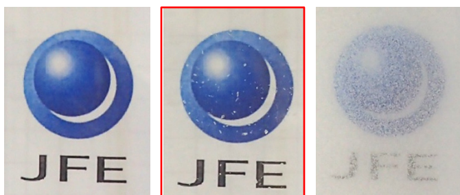
図2 ポリカーボネートのグラベロ試験
