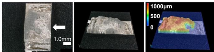
接着面のCCD像および計測画像
