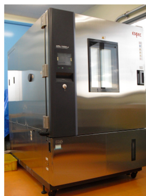
-45～150℃可能な ハイパワー恒温恒湿試験機 (1.1×1×1m、 200kgサンプルまで試験可能)
