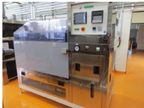
酸性環境対応した複合サイクル試験機 (合計3台保有しており、多数の試験が可能です。)
