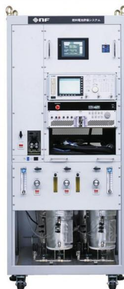
図1. 発電試験装置の外観
