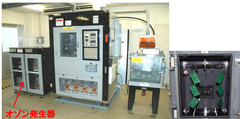
図1 ガス腐食試験機(オゾンを含む5種混合ガス対応可能) (写真右: 電子部品サンプルとCuクーポンを同時に設置しガス腐食試験を実施している例)
