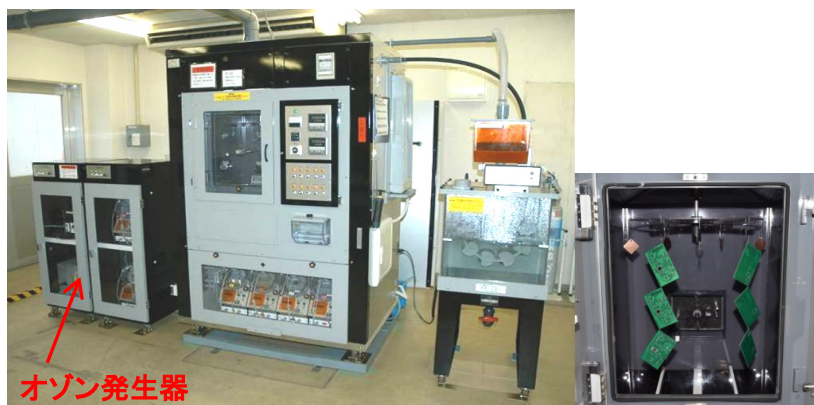
図1 ガス腐食試験機(オゾンを含む5種混合ガス対応可能)
