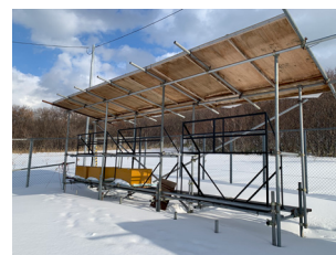
図6 軒下大気暴露架台
