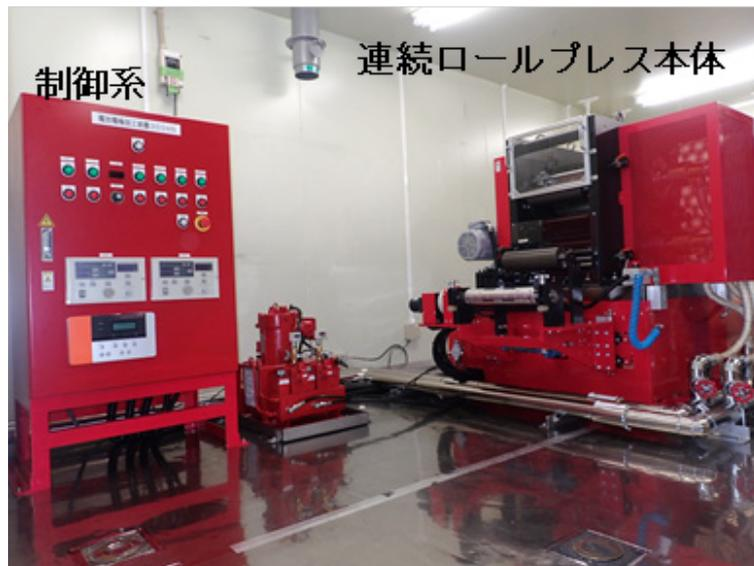
写真1 当社ドライルーム内に新設した連続ロールプレス機
