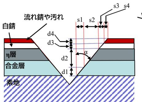
図2 カット部の模式図(断面方向)
