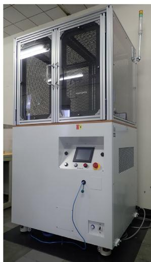
絶縁破壊耐電圧試験機
