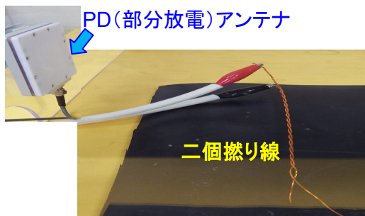
二個撚り線の絶縁破壊試験の外観
