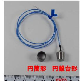
図1 プローブ電極
