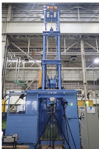
大開口落錘試験機(左:全体、右:試験体設置スペース)
