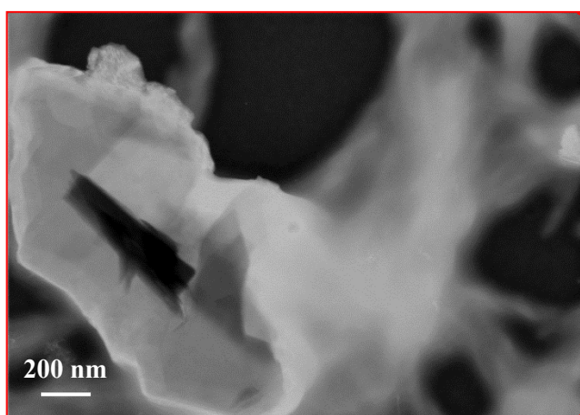
図3 二硫化モリブデングリースのSTEM暗視野像 (左: 拡大像)
