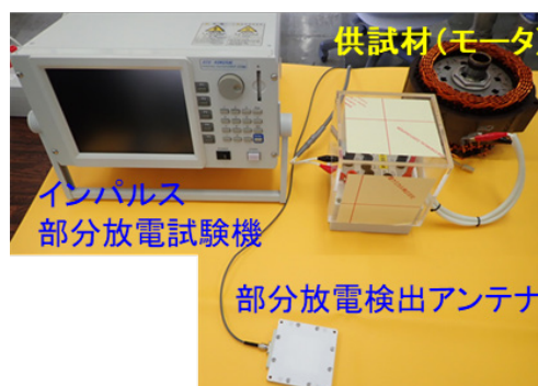
部分放電試験の外観
