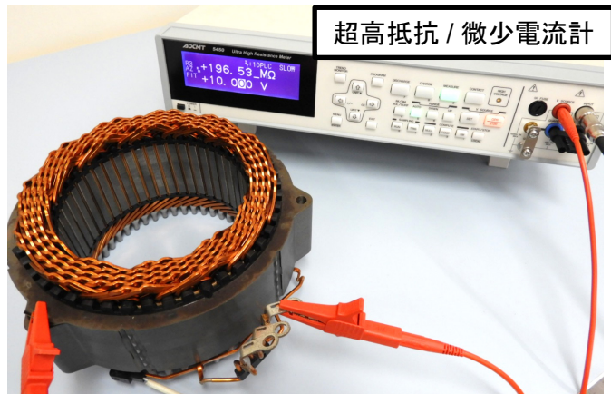
絶縁抵抗測定の様子
