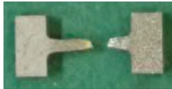
引張試験後の微小試験片
