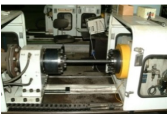
島津製作所製 20kN疲労試験機 (歪制御低サイクル疲労試験対応)
