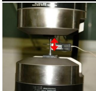
島津製作所製 20kN疲労試験機 (歪制御低サイクル疲労試験対応)
