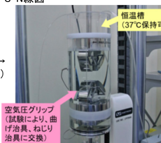
インストロン社製→ 10kN疲労試験機(溶液内疲労試験)
