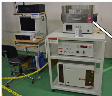
鋼材中水素測定システム
