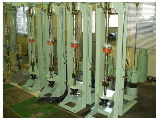
定荷重引張遅れ破壊試験機
