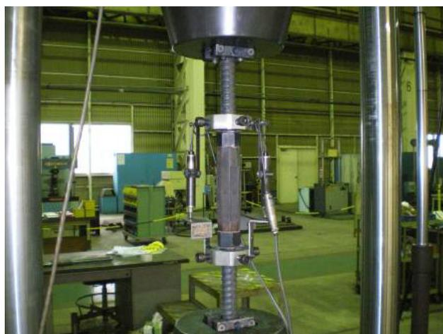
写真1 鉄筋継手性能判定試験写真例
