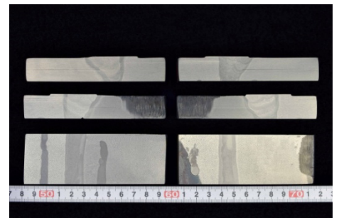
工場溶接 代替エンドタブ 試験片
