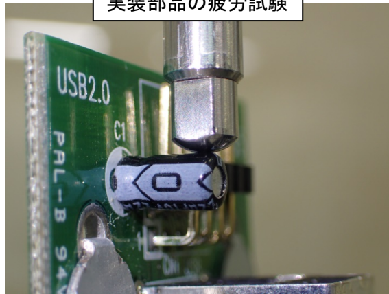
実装部品の疲労試験
