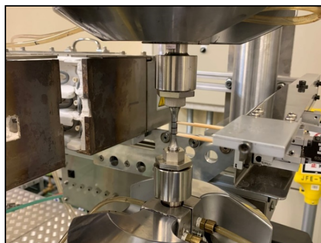
試験片取り付け状況
