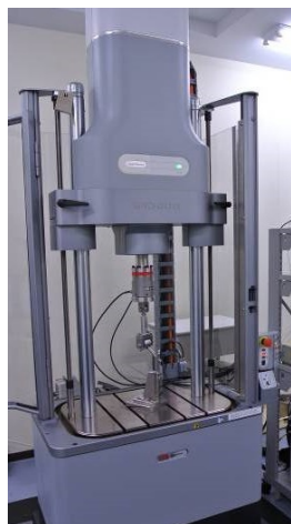
10kN+100N・m二軸疲労試験機
