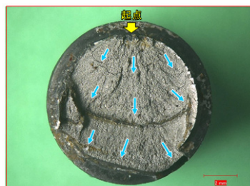
遅れ破壊の破面外観例
