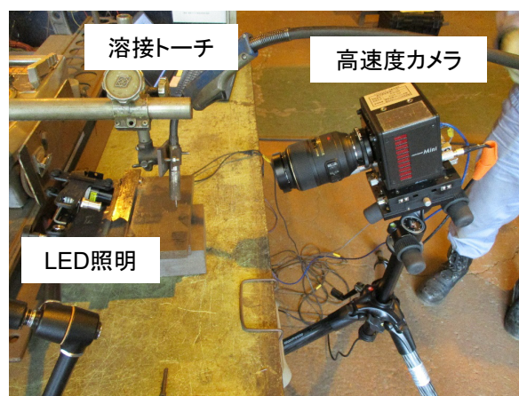
アーク溶接溶融池の撮影状況
