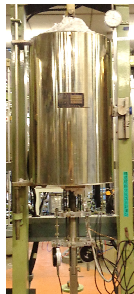
図2 Ar雰囲気クリープ試験装置
