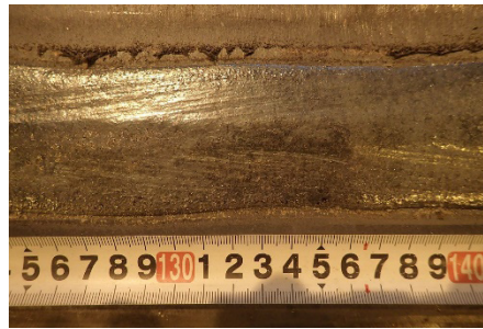
写真2 板厚70mm材の1パス溶接ビード外観
