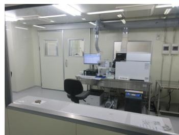
クリーンルーム(クラス5~6)内の誘導結合プラズマ質量分析装置(ICP-MS)
