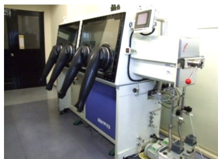
電解液を回収する雰囲気制御グローブボックス
